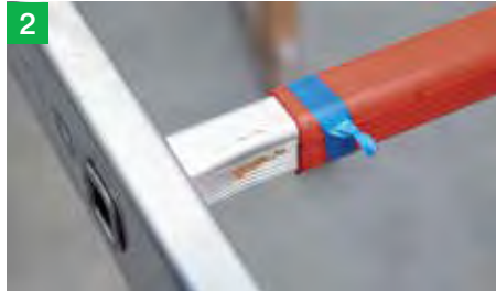
Beschädigte, zu tauschende Sprosse. Hinweis: max. zwei Sprossen nach dieser Methode an einem Leiterteil auswechseln.
