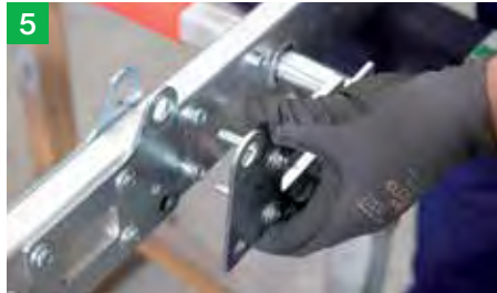
5 Scharnierplatte inkl. Rastriegel einsetzen.
