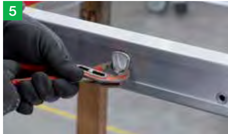
Das Sprossenende mit einer Wasserpumpenzange zusammendrücken.
