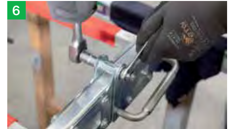
6 Verschraubung Scharnierplatte festziehen.
