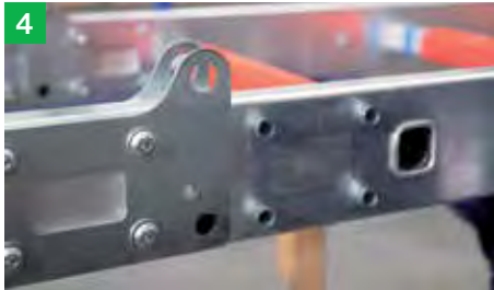
4 Scharnierplatte inkl. Rastriegel entfernen.
