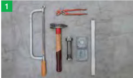
Säge, Hammer, Wasserpumpenzange, Aufweitgerät, Bördelgerät, neue Sprosse, Schraubzwingen
