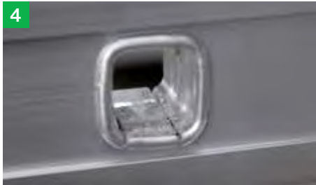
Gebördelte Sprossenenden an zwei Stellen einsägen. Achtung: Seitenholm der Leiter dabei nicht beschädigen.
