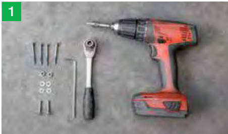
1 Akkuschauber mit Biteinsatz TX 25, Ratsche und Inbusschlüssel
