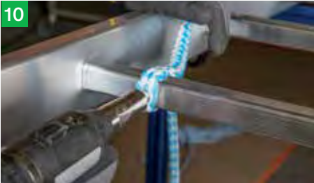
10 Mit Nietzange oder Blindnietsetzgerät vernieten
