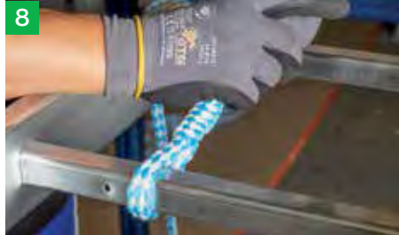
8 Einführen bis die Kausche fest auf der Leitersprosse sitzt
