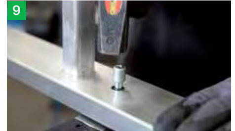
9 Mit dem Schlosserhammer aufschlagen
