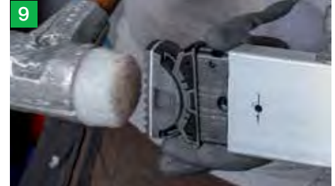
9 Neuen Leiterschuh mit dem Schonhammer einschlagen. Beim Einschlagen muss das untere, bewegliche Leiterschuheteil möglichst senkrecht stehen
