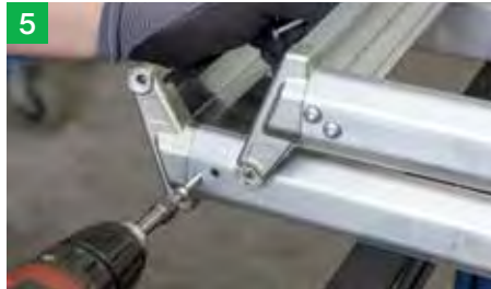
5 Neue Stufe und Scharniere einsetzen, an den vorhandenen Bohrungen verschrauben (Schraube mit blauer Klebesicherung und Sperrverzahnung. Anzugsdrehmoment ca. 10 Nm)
