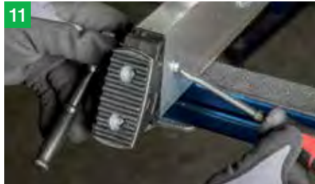
11 Mit Schraube M5 x 30 und selbstsichernder Mutter M5 sichern (optimal mit 6 Nm)
