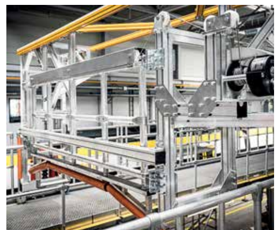
An Quergeländern sind Frontalabsturzicherungen befestigt. Diese können einfach abgesenkt und an die Zugkontur angepasst werden.
