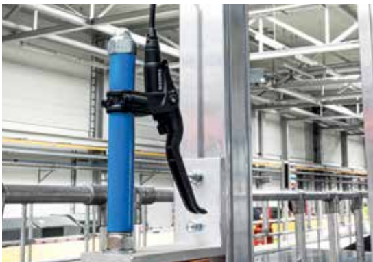
Hydraulikbremshebel nach Totmannprinzip.
