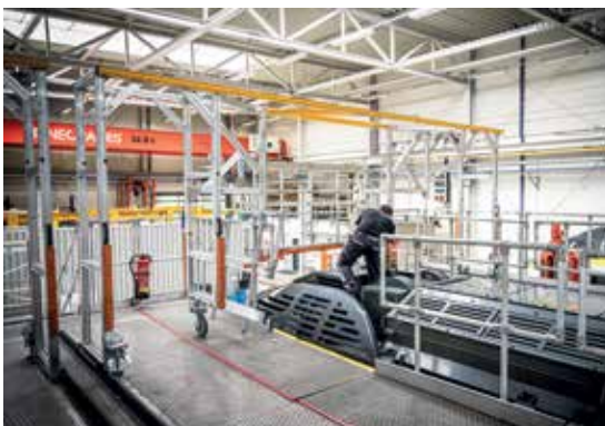
Mit der höhenverstellbaren Frontabsturzversicherung können Wartungs- und Reparaturarbeiten auf dem Zugdach sicher ausgeführt werden.
