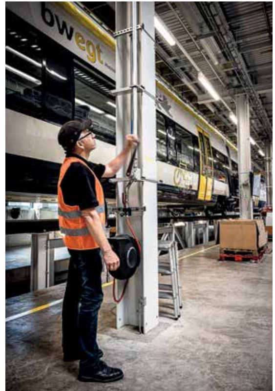
An die Triebzüge lassen sich die Plattformen ganz einfach mit Spaltmaß Null andocken.
