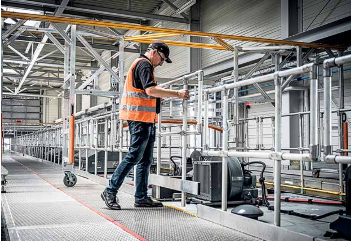
Seitlich ist der gesamte Arbeitsbereich innen wie außen mit steckbaren Geländern mit einer Höhe von 1.100 mm ausgestattet.
