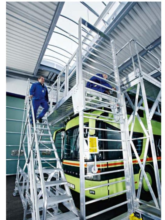
**Flexibilität:** Mit unseren beidseitigen oder einseitigen Arbeitsbühnen sowie variabler Länge bieten wir maximale Flexibilität für verschiedene Produktions- und Wartungsszenarien. Dank leichter Manövrierbarkeit und Feststellbremsen können unsere Sonderkonstruktionen problemlos an verschiedenen Arbeitsstationen eingesetzt werden.
