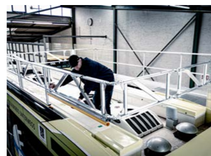
Panier de protection latéral pour sécuriser la zone de travail, en option avec des plinthes abaissables
