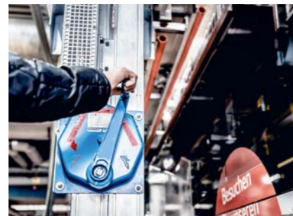
Élargissement de la plate-forme par treuil à câble
