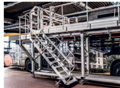
Escalier avec main courante et garde-corps ainsi que porte de sécurité à fermeture automatique
