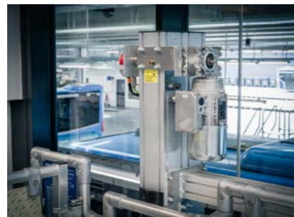
Réglage de la hauteur avec contrôle de synchronisation (hauteur de plate-forme 2,10 m → 3,85 m)
