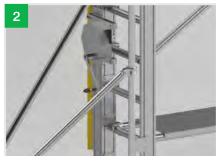
2. Plattformverstellung Plattform höhenverstellbar mittels zwei Handkurbeln im Raster 280 mm
