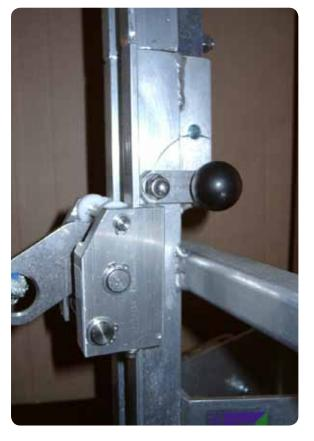
Nachdem ein Aufsteckteil auf das untere Leiterteil aufgesteckt wurde, den Sicherungsverschluss in senkrechter Stellung bringen.
