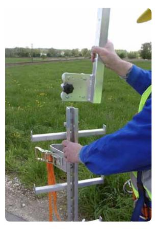
Durch ziehen des Federbolzens nach außen kann die Aufzugsvorrichtung im Sprossenabstand verstellt werden.
