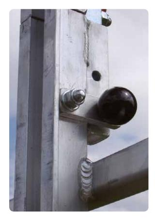
Dieses Leiterelement ist gegen Abheben gesichert. Der Sicherungsverschluss befindet sich in senkrechter Stellung.
