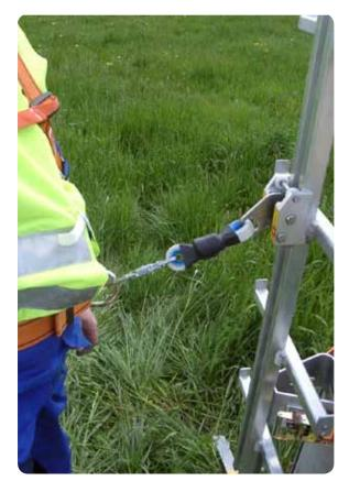
Leiterelement in den Halter des unteren Leiterelements einstekken.
