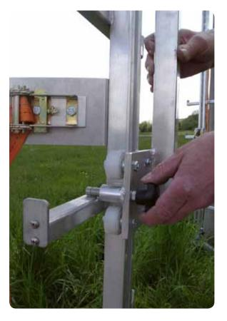
Karabienerhaken des Sicherungsläufers in die vordere Öse des Auffanggurts einhängen.
