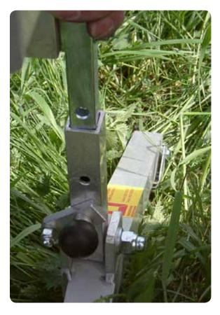
Sicherungsverschluss nach außen ziehen und in die Bohrung des Halters einstecken. Prüfen ob das Leiterteil im Halter gesichert ist.
