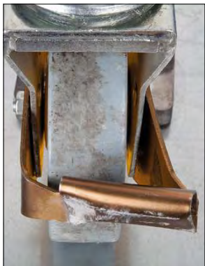
Verformung des Fußpedals aufgrund eines heftigen Aufpralls. Vermutlich sind die obere Befestigungsplatte und das Rollenlager auch verformt.
