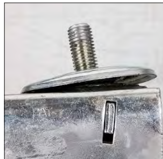
Verformung der Befestigungsplatte aufgrund eines einzigen heftigen Aufpralls oder mehrerer weniger heftiger Aufpralle. Selbst wenn sich die Laufrolle ansonsten in gutem Zustand befindet, muss sie ersetzt werden.
