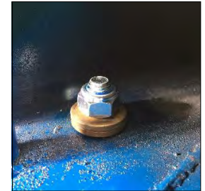
TELLERFEDERN NICHT SO MONTIEREN
