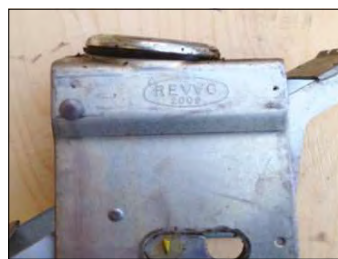
Verformung der oberen Befestigungsplatte aufgrund eines einzigen heftigen Aufpralls oder mehrerer weniger heftiger Aufpralle. Selbst wenn sich die Laufrolle ansonsten in gutem Zustand befindet, muss sie ersetzt werden.
