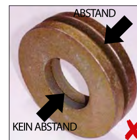
TELLERFEDERN NICHT SO MONTIEREN
