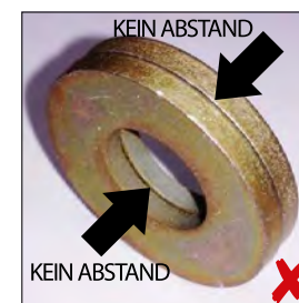
TELLERFEDERN NICHT SO MONTIEREN
