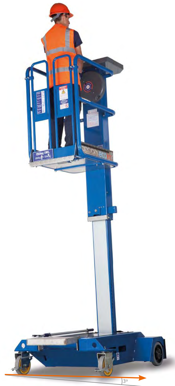
Das windtaugliche gerät kann bei Neigungswinkeln bis 3° und bei Windstärken bis 12,5 m/s betrieben werden.
