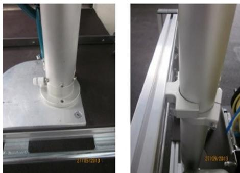
6. Lichtmast mit Zylinderschraube M6x20 und U-Scheibe A6 auf Grundplatte schrau-
