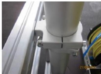
7. Nachjustierung der Handpumpe. Schrauben der Klemmschelle, anstelle des Lichtmasts oder der Handpumpe lösen. Die Handpumpe in die gewünschte Position bringen, die Schrauben wieder fest drehen.
